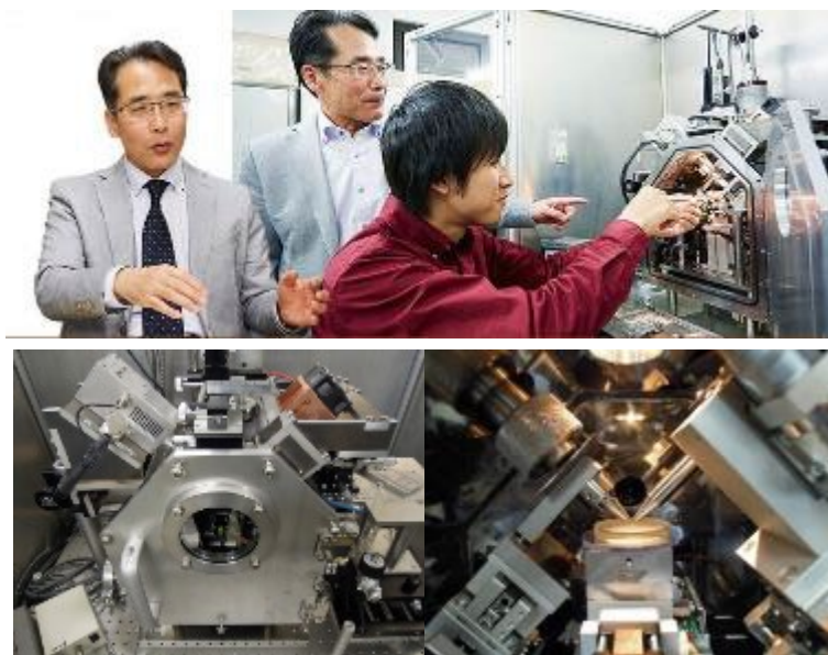
国内で唯一市大が保有する共焦点3次元蛍光X線装置
